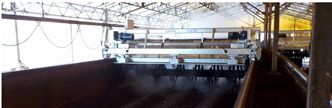
■ スクープ式からの載せ替えが可能なロータリー式 ■ 既存建屋の建て替えが必要ありません
